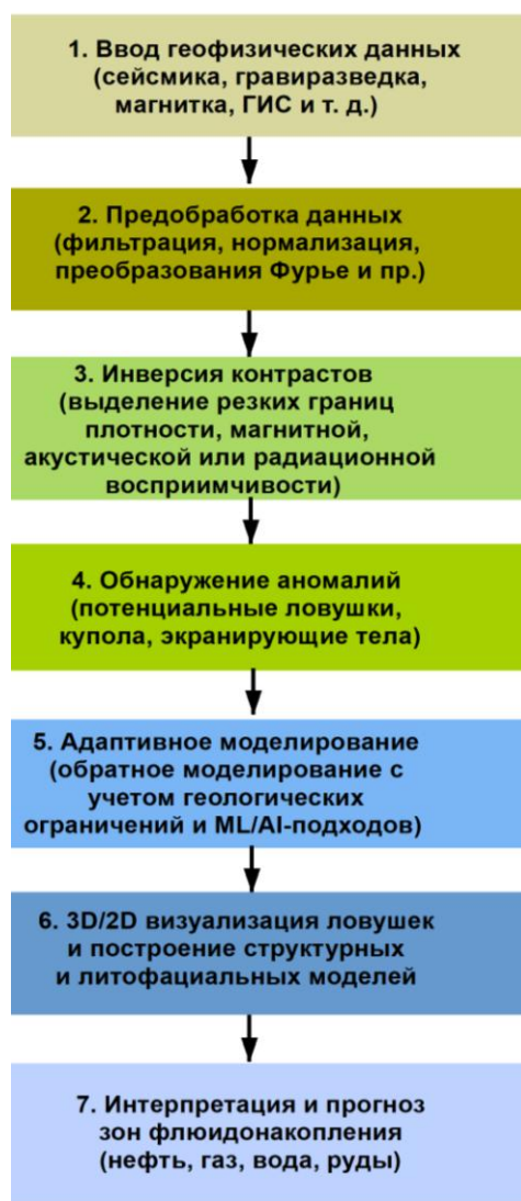
Рис.6- Блок-схема: инверсия контрастов и адаптивное моделирование (обратное моделирование с учетом геологических ограничений и ML/AI-подходов) сложных и нелинейных зависимостей в геологических разрезах.
