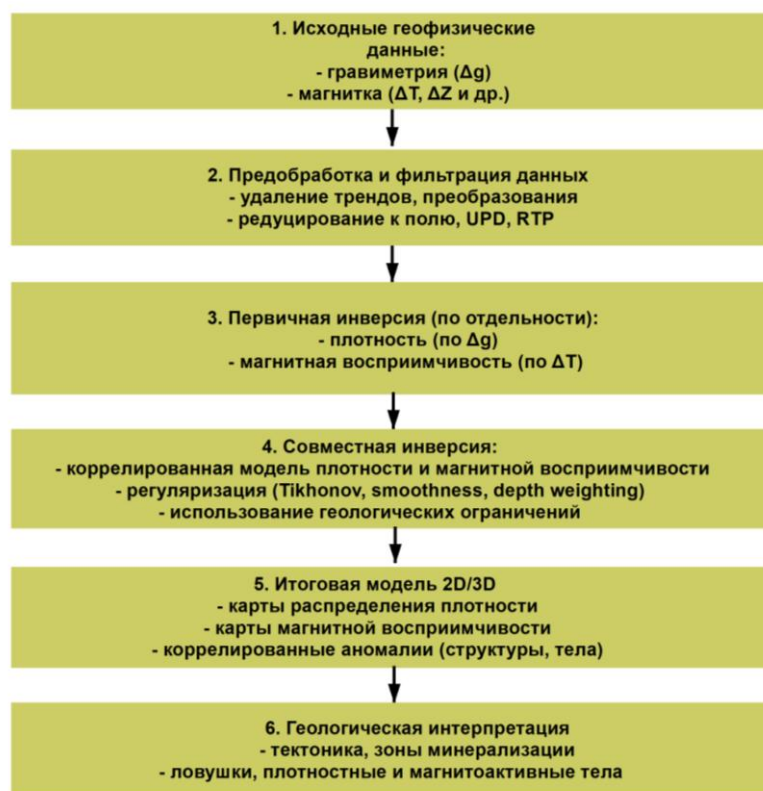
Рис.8- Схема: совместная инверсия гравитационных и магнитных данных в ПО IP_Seismic
